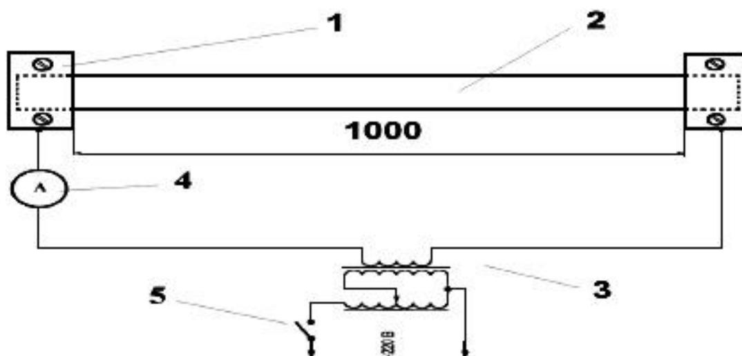
1 - разъемные сдвоенные медные пластины; 2 - испытываемый образец; 3 - регулируемый источник напряжения; 4 - амперметр; 5 - выключатель
