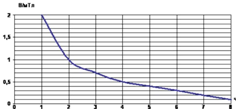
**ПДУ производственных воздействий МП ПЧ в зависимости от времени пребывания
